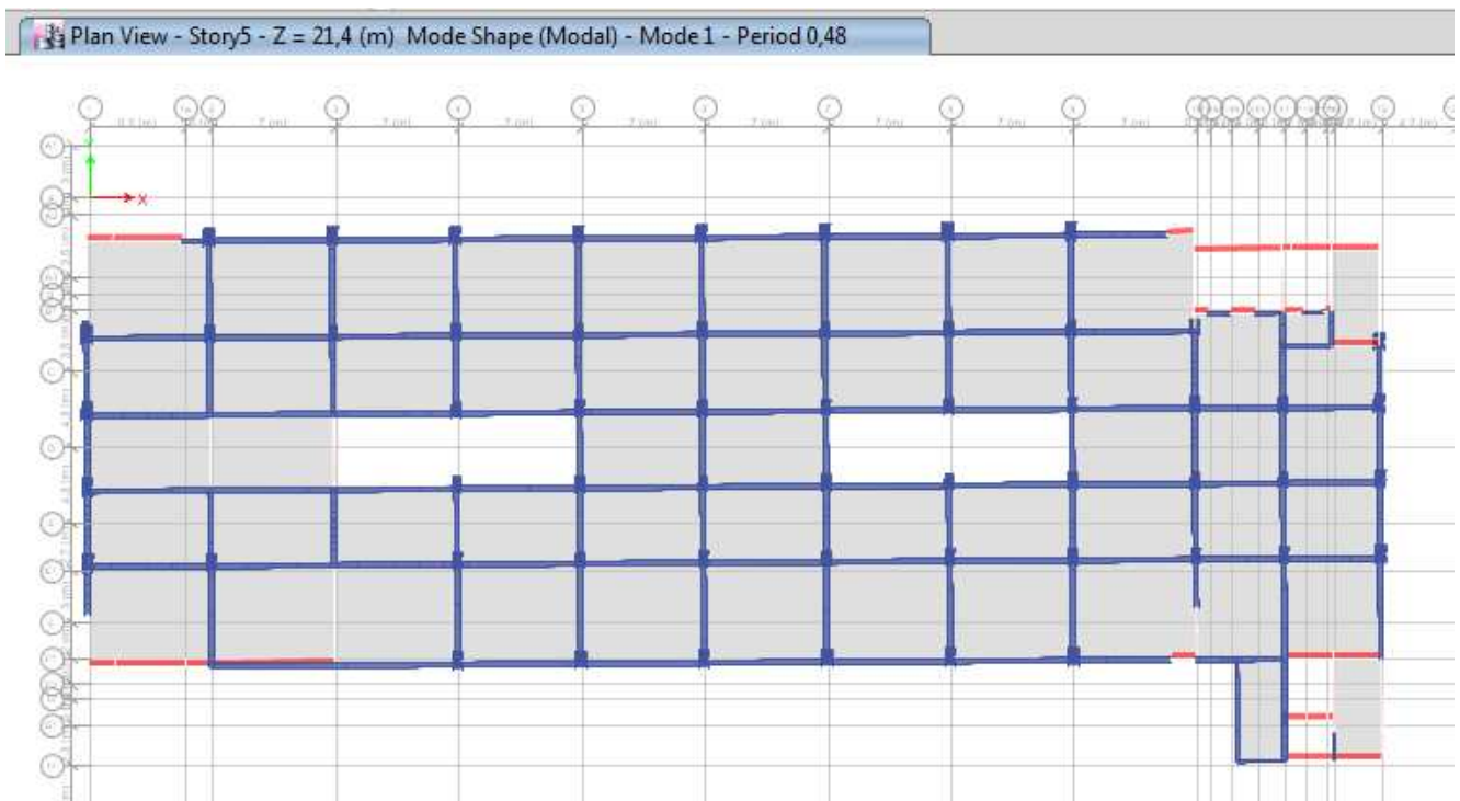
Fig. 15(a). Primer Modo de vibrar del Nuevo diseño propuesto: 0.48 segs.
